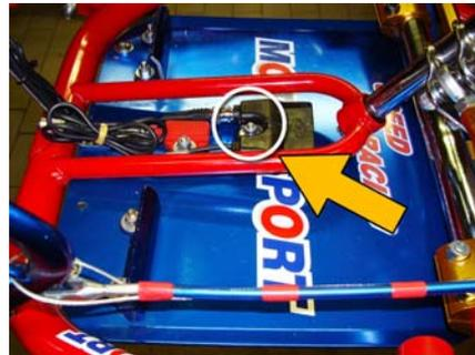
L'antenna GPS deve essere parallela al terreno e deve avere l'angolo visuale più ampio possibile verso il cielo, così da ricevere il numero massimo di satelliti collegati al sistema: si suggerisce quindi di installarlo sul porta numero frontale del kart (vedi foto sotto).
