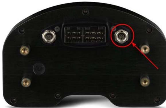
Per collegare un **MXL Pro** si colleghi il **Modulo GPS** al cavo CAN etichettato EXP (espansione) del cablaggio dello strumento.
