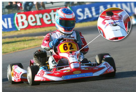
La targa porta numero è in plastica: ciò comporta che il magnete non potrà tenere l'antenna fissata. Per un'installazione ottimale si suggerisce di utilizzare una striscia di Dual Lock – Velcro ®
