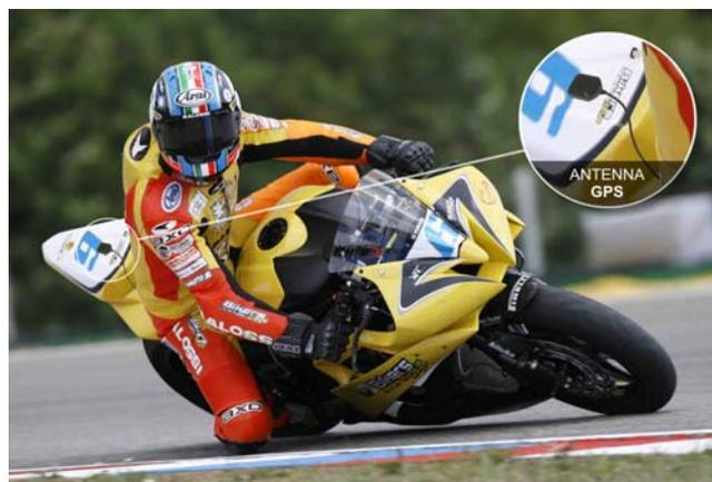
Si installi il **Modulo GPS** vicino alla sella così che sia il cavo CAN (meno sensibile alle onde elettromagnetiche) e non l'antenna GPS a passare vicino al motore.
